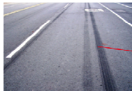
車輪鎖死時，煞車滾動滑成一直線，無法控制方向
